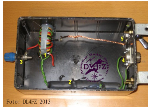
Abb.4 Eine Ausführung des Kopplers mit einem 1:3 Balun kommerzieller Fertigung(1); 2 eingeschrumpfte Gleichtaktwellen-Drossel, 3 Antennenklemme, 4 Koaxbuchse, 5 Anschluss des Gegengewichts
